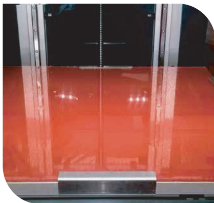
Large lit chauffant en verre pour travaux en hautes températures
